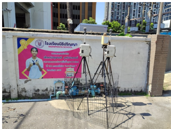
ติดตั้งเครื่องตรวจวัดฝุ่นละออง เครื่องตรวจวัดเสียง ที่โรงเรียน นิธิปริญา
